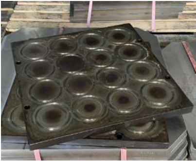
Khuôn kích thước 300x300mm Vật liệu: Thép
