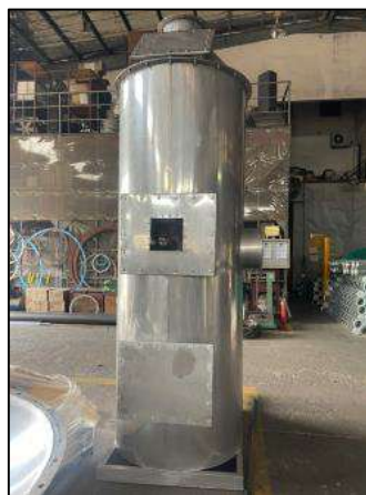
Hình 3.11. Hình ảnh công trình xử lý khí thải tại phòng sấy của xưởng ORA
