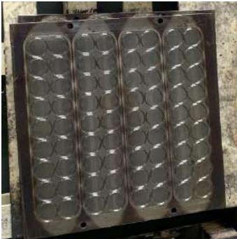
Khuôn kích thước 600x600mm Vật liệu: Thép
